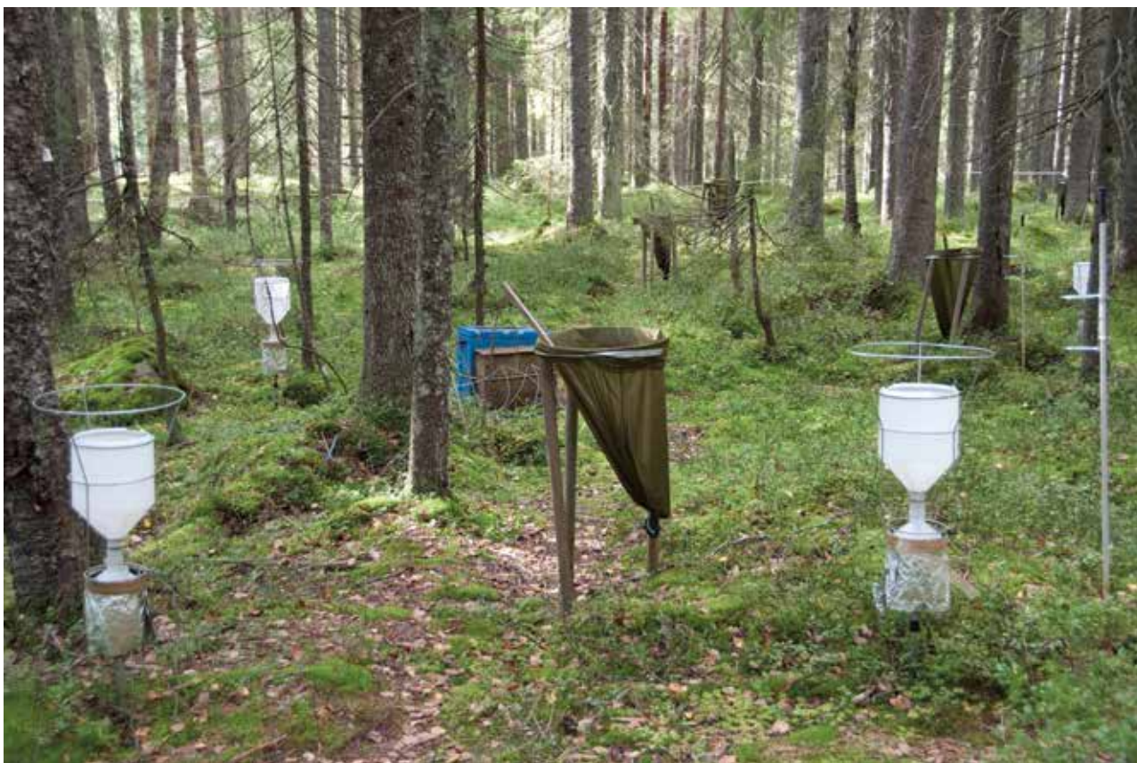
Oppsugingsanlegg for jordvann, strøsammlere og kronedryppssamlere på en intensiv skogovervåkingsflate. Foto: Volkmar Timmermann
