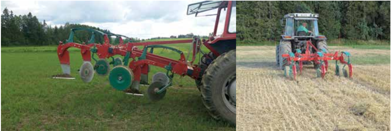
I nye forskningsprosjekt har vi sammen med Kverneland Group Operations AS utviklet nye prototyper for kontroll av rotgras «Horizontal rot-skjæreren» hvor målet er god bekjempelse kombinert med minimal bearbeidelse av jorda. Foto: V. Truls Olve Terjesønn Hansen, h. Lars Olav Brandsæter.
