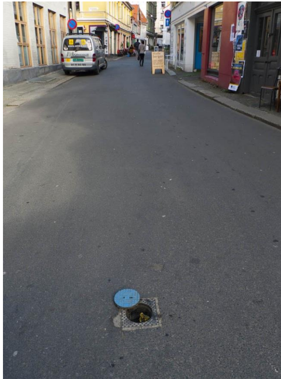
Figur 1 Miljøbrønn VMB01 Skostredet Brønn var 4 m dyp med grunnvann på 1.80 m fra overflaten.
