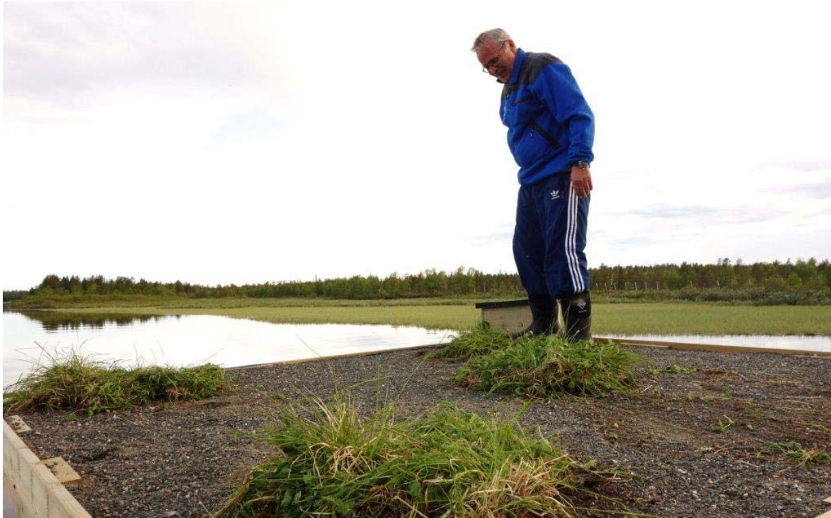
Figur 14. 15.juni legger Arild Lyssand fem biter torv med gress på 0,5 m2 i hjørnene på plattformen og en på midten. Foto: Bjørn Frantzen
