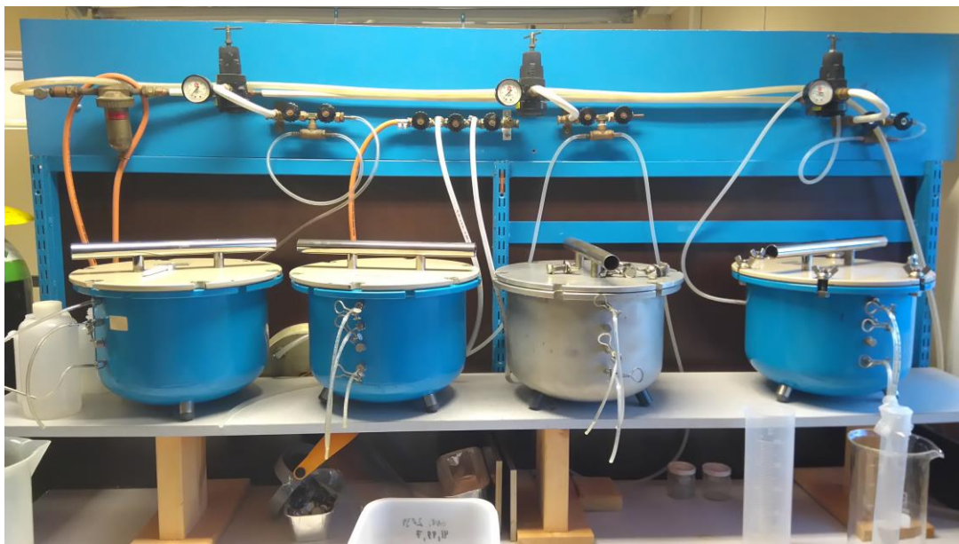
Bilete 3.5. Trykkammer for jordfysiske målingar på laben på Apelsvoll. Foto: Synnøve Rivedal.
