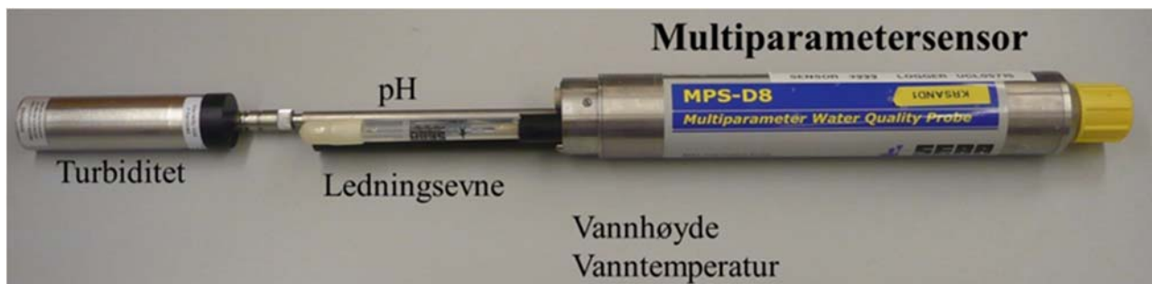
Figur 2: Multiparametersensor for automatisk overvåking av vannkvalitet.
