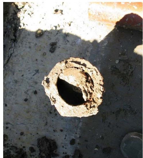
Figur 6. De gamle grøftene var av teglstein fungerte dårlig. Det var lekkasjer og mye sedimentavleiring.
