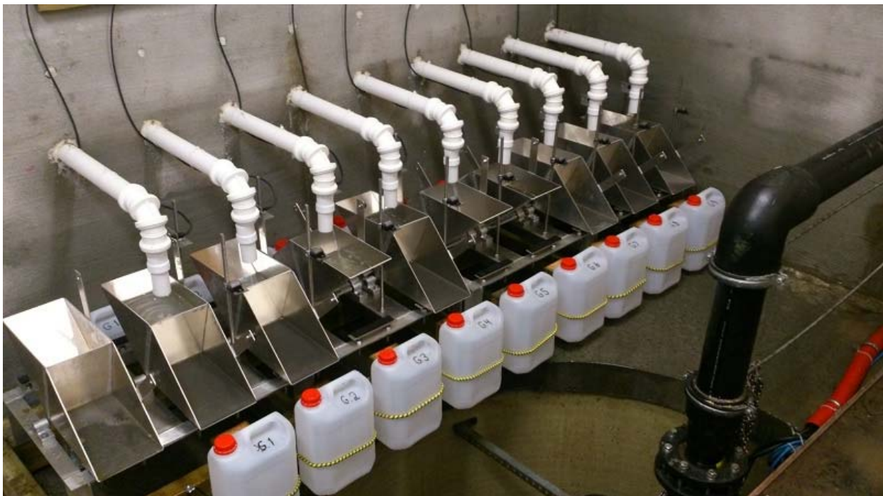
Figur 15. Overflate- og grøftevann fra rutene renner gjennom rør inn i målehytta, og samles i vippekar. Når vippekaret er fullt, vipper det, og vann strømmer over plastkannene. I disse er det hull som vann kan renne inn gjennom. Slik får man tatt vannprøver.
