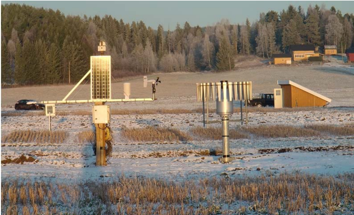
Figur 16. Klimastasjonen med stativ påmontert ulike sensorer til venstre og nedbørmåler til høyre. Sensoren for innstråling sitter på stativets venstre arm, og sensoren for temperatur og luftfuktighet på høyre arm, med vindmåler lengst til høyre. Midt på stativet sitter en logger (motsatt side) og loggerbatteri (denne side), solcellepanel og øverst et web-kamera.
