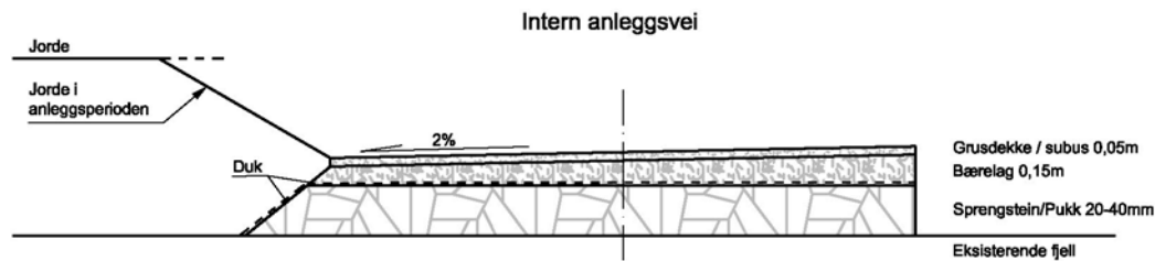
Figur 5.4 Normalprofil intern anleggsvei
