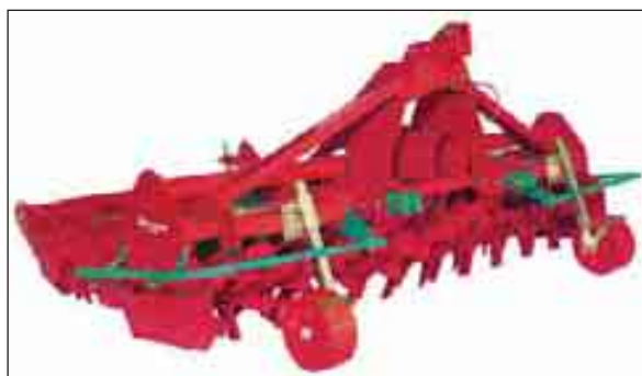
Figur 1.128 Rotorharva kan dele opp formeringsorganer, men må være av en kraftig type for å kunne gå dypt nok, spesielt på stenfull jord. Foto: Kvernland (gjengitt med tillatelse).
