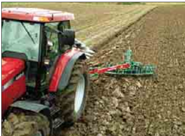
Figur 1.51 Jordpakker montert på plogen. Jordpakkeren pakker sammen jorda slik at de store porene i jorda blir mindre og kan holde på vann. Dette er ikke skadelig pakking. Jorda blir smuldret opp på overflaten. Er en meget nøye med innstillingen og har harvtinder foran og bak pakkeren, kan en faktisk gjøre ferdig såbed på lettere jord. Vendeteigene må sjølsagt sloddes og harves ekstra. Fabrikat og foto: Kvernland (gjengitt med tillatelse).
