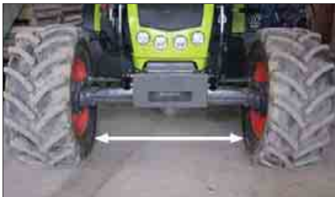
Figur 1.42 Avstanden mellom framdekkene (målt på utbulingen) skal være 2 til 11 cm større enn avstanden mellom bakdekkene dersom bakdekkene er smalere enn 50 cm. Har en bredere dekk bør den være større, gjerne opptil 20 cm når bakdekkene overstiger 60 cm. Foto: Kjell Mangerud.
