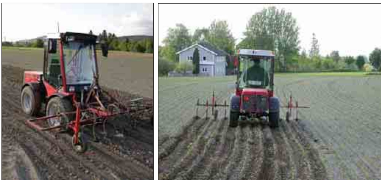
Figur 1.100 Frontmontert radrenser på liten spesialtraktor som bonden ellers bruker til snøbrøyting for kommunen. Foto: Lars Olav Brandsæter.
