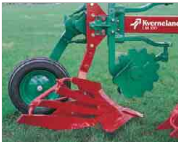
Figur 1.32 Stripekropp er et kompromiss i jord som kleber på veltefjøla og som samtidig har mye sten. Fabrikat og foto: Kverneland (gjengitt med tillatelse).
