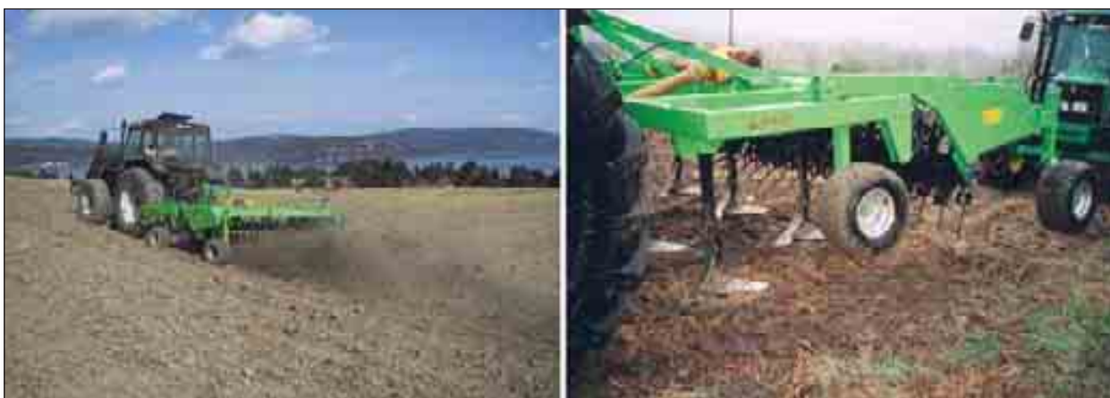
Figur 1.113 Kvik-Up harva er effektiv til å legge kvekejordstengler på jordoverflaten, men krever stor motorkraft. Foto: Silja Valand.
