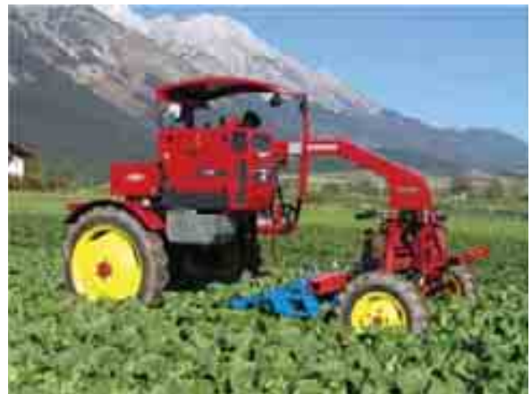
Figur 1.99 Moderne radrensertraktor, fabrikat 'Rath'. Foto: Produsent.
