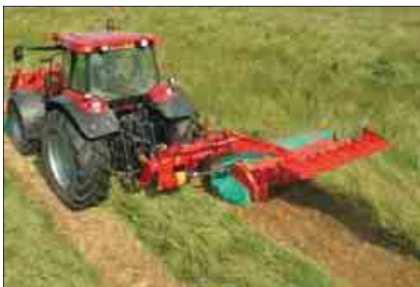
Figur 1.106 Skiveslåmaskin med stengelknekker og spredeskjerm kan egne seg godt til å slå ned gras og ugras. Skjermen må stilles for spredning, ikke samling som på bildet. Fabrikat og foto: Kvernlund (gjengitt med tillatelse).
