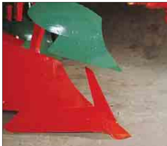
Figur 1.33 Knivristel festet under spissen. Fabrikat og foto: Kverneland (gjengitt med tillatelse).
