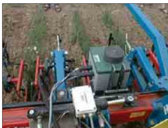
Figur 1.102 Datamaskina tolker om raden ligger på riktig sted i bildet. Dersom den ikke gjør det, påvirkes den elektrisk styrt hydraulikkventilen, og radrenseren forskyves sideveis med den hydrauliske sylinderen.
