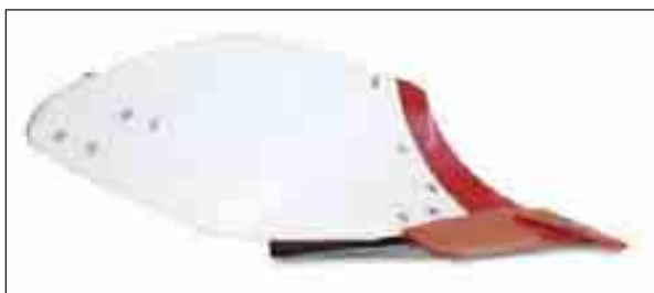
Figur 1.31 På en plogkropp med veltefjøl av plast vil ikke jorda klebe på. På stenholdig jord, spesielt jord med kantete sten slites den mer enn veltefjøl av stål. Fabrikat og foto: Kverneland (gjengitt med tillatelse).
