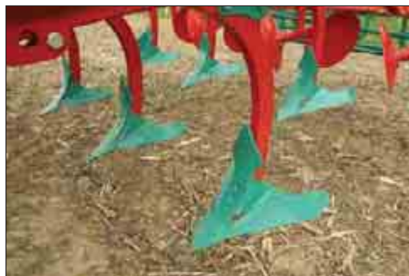
Figur 1.125 Skålgrubberen har kraftige tinder med søkende spiss og gåsefotskjær. Bak de bakerste tindene går det skåler som jamner ut etter harvtindene, og aller bakerst er det en pakkevalse som både pakker jorda sammen og virker som dybdehjul. Fabrikat og foto: Kvernland (gjengitt med tillatelse).
