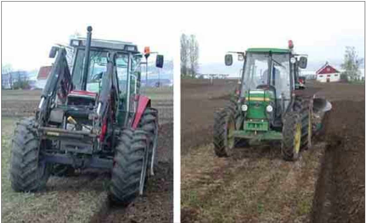
Figur 1.114 I flerårige forsøk på Apelsvoll (Toten, Oppland) og Kvithamar (Stjørdal, Nord-Trøndelag) ble tre forsøksfaktorer testet ut: (i) Traktortyngde, (ii) Hjulplassing (se bilde til venstre: tradisjonell hjulplassing i fåra, til høyre 'på land') og (iii) pløedybde, 15 cm og 25 cm. Foto: Ragnar Eltun.
