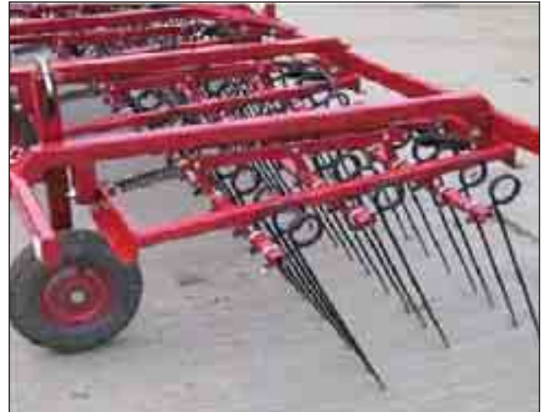
Figur 1.67 CMN. Denne harva leveres bare med rette lange tinder. Senteravstand 50 mm. Flere produsenter har tilsvarende harver. Foto: Kjell Mangerud.
