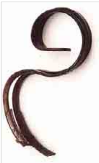
Figur 1.53 Kombinasjonen av strekt tinde (den øverste av de to) og slitt spiss kontra ny tinde og ny spiss kan gi stor forskjell i harvedybde. Foto: Kjell Mangerud.
