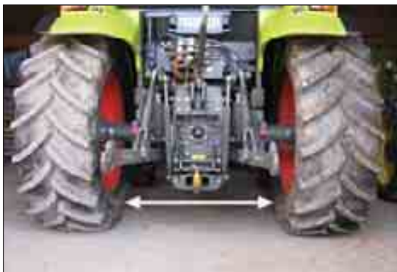
Figur 1.41 Avstanden mellom innsiden av bakdekkene (målt på utbulingen) bør være tre ganger veltebredda pluss 2 til 11 cm. For en 14" plog som velter 35 cm bør denne avstanden være mellom 107 cm og 116 cm. Om det avviker noe, kan en forskyve plogen sideveis på dragakselen. Foto: Kjell Mangerud.
