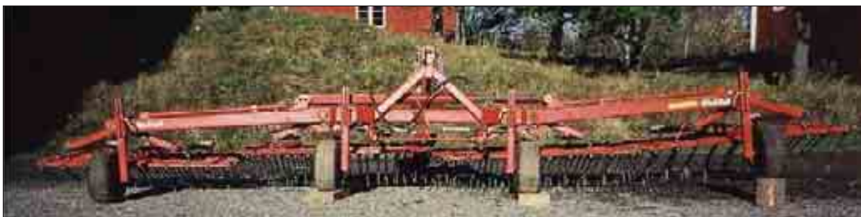
Figur 1.77 Dersom ugrasharva har hjul på sidefeltene og en skrur inn stoppeskruene for sidefeltene kan en få harva til å følge terrenget. Bildet viser at sidefeltene kan gå lågere eller høyere enn hovedfeltet. På denne harva har en forlenget innfestingen til sylindren som slår sammen harva. Foto: Kjell Mangerud.
