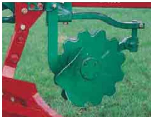
Figur 1.34 Takket rulleskjær går bedre når det er mye seig halm. "Tannhjulseffekten" gjør at det går rundt. Dette reduserer muligheten for at halm henger seg på forplogen. Fabrikat og foto: Kverneland (gjengitt med tillatelse).
