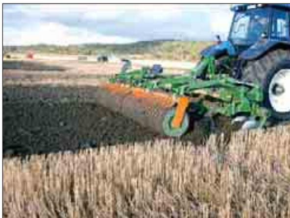
Figur 1.126 Moderne skålharv hvor hver skål har eget fjærende oppheng. Foto: Kjell Mangerud.
