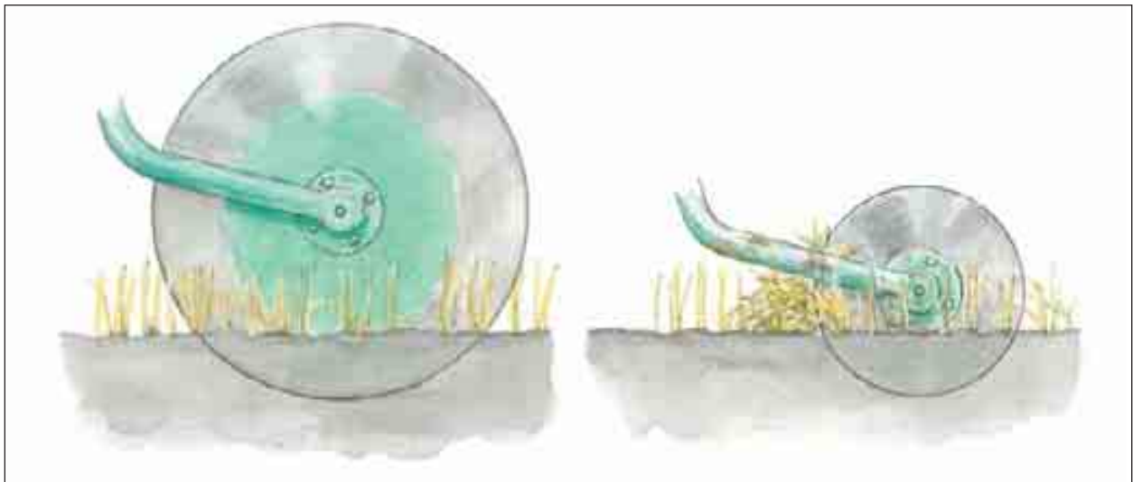
Figur 1.35 Det er viktig å skifte skiveristelen før den blir for liten. Mellom jordoverflata og eggen til en ny skiveristel vil det være en spiss vinkel. Skiveristelen vil da kunne klippe av halm og planterester. Etter hvert som skiveristelen slites og en stiller den ned for at den skal gå dypt nok, blir denne vinkelen mer og mer butt. Det er større sjanse for at halm og planterester skyves foran skiveristelen og blokkerer hele ploegen, spesielt dersom halmen er fuktig. Tegning: Hermod Karlsen.
