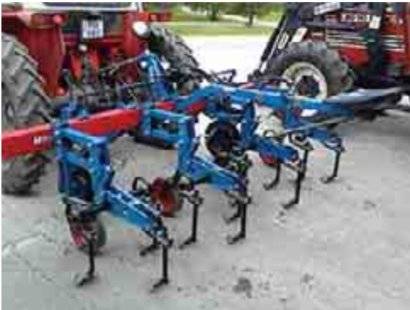
Figur 1.97 Eksempel på en moderne radrenser. Et profilert stålrør er festet i trepunktoppheget på traktoren. Hovedramma har bære-/styre-hjul. På hovedramma er det i dette tilfelle festet fire parallellogram, hvert med feste for tre tinner. Det er et dybdehjul for hvert parallellogram. Foto: Kjell Mangerud.
