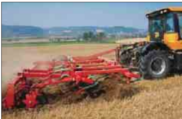
Figur 1.124 Djupharv med skåler som jamner ut og med pakkevalse bak. Fabrikat og foto: Kvernland (gjengitt med tillatelse).
