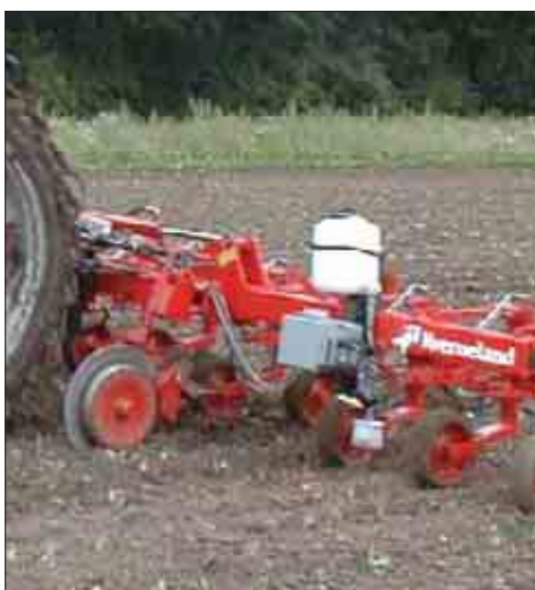
Figur 1.101 Et digitalt kamera er festet på radrenseren. Det tar bilder med korte mellomrom og sender opplysningene direkte til datamaskina.
