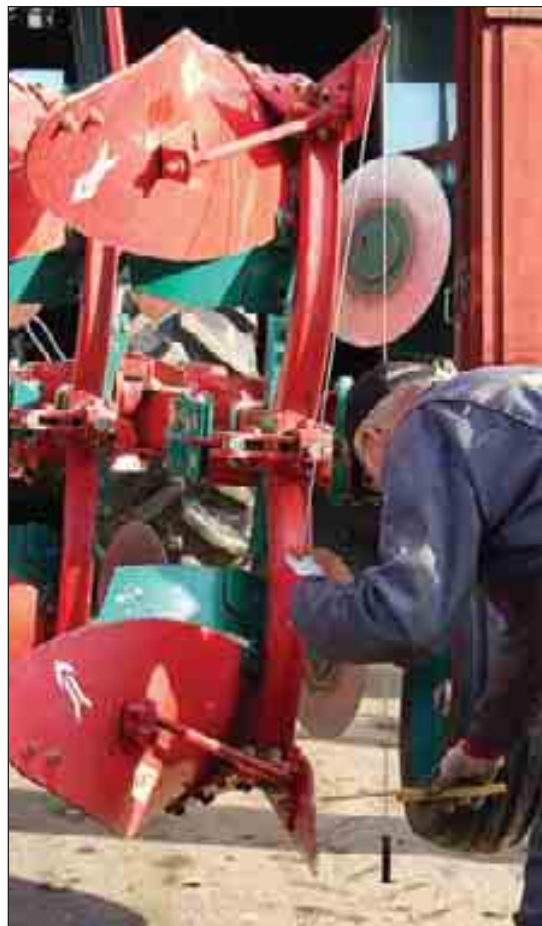
Figur 1.44 Når en bruker vendepløgen er det viktig at den vender likt begge veger. Kjør traktorens bakhjul (som må ha likt lufttrykk) inn på et vannrett golv. En loddsnor henges ned fra øvre landside. Mål avstanden fra loddsnora inn på den nedre landsida. Vend ploegen, heng på loddsnora igjen og kontroller at det er likt. Hvis ikke, justeres lengden av løftestagene slik at det blir likt. Foto: Kari Bysveen.
