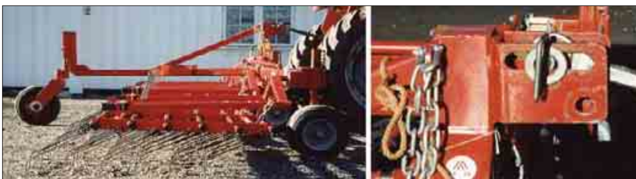
Figur 1.76 Ved å sette på hjul bak og lage et avlangt hull for toppstanga kan en få harva til å følge terrenget. Foto: Kjell Mangerud.
