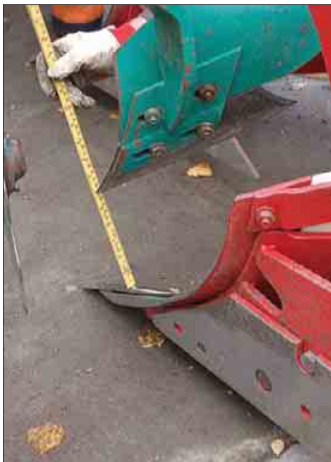
Figur 1.43 Avstanden fra spissen på forploegen vinkelrett inn på spissen skal være ca. 5 cm mindre enn pløedybde. Pløyer en 20 cm dypt skal avstanden være 15 cm. Foto: Kari Bysveen.
