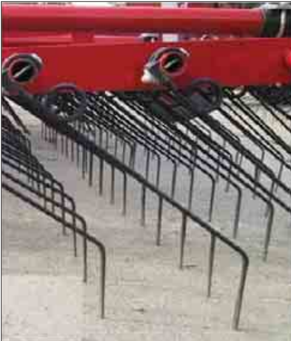
Figur 1.66 Einböck harv med knekte tinder og senteravstand mellom tindene på 25 mm. Slike harver kan leveres med 7 og 8 mm knekte tinder og 8 mm rette tinder. Flere produsenter har tilsvarende harver. Foto: Kjell Mangerud.
