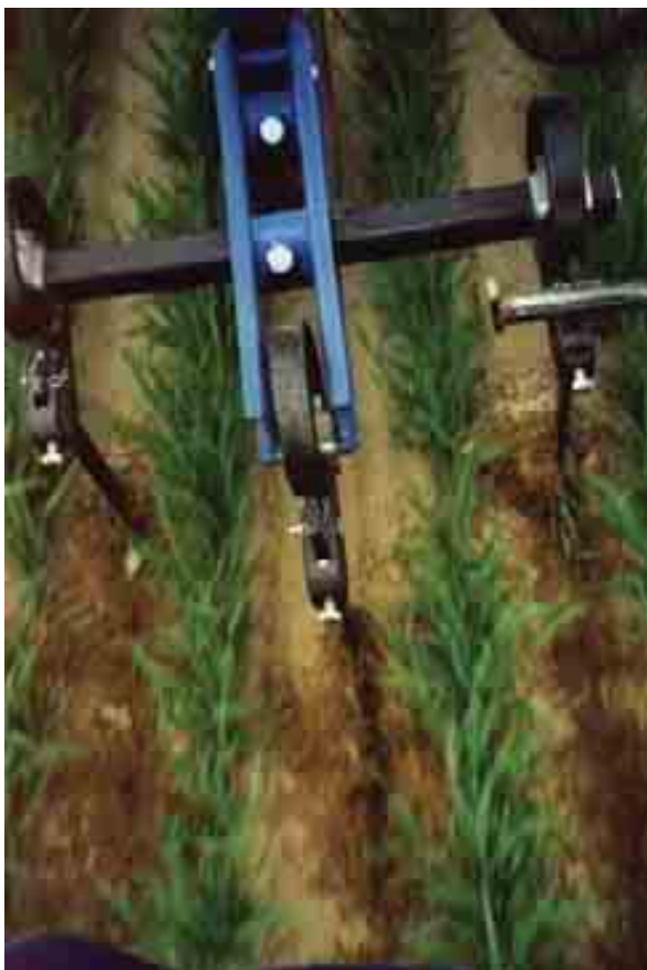
Figur 1.96 Radrensing i korn. Gåsefotskjær skjærer av ugraset mellom radene. Her er det tre skjær som sitter på samme parallelogram med felles dybdehjul. Foto: Kjell Mangerud.
