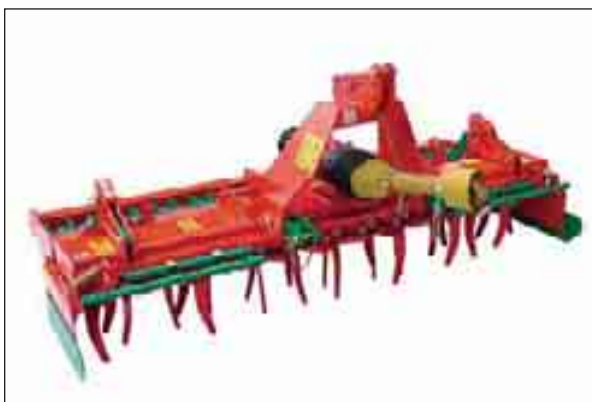
Figur 1.127 Lett fres. Denne har pakkevalse bak. Uten den kan formeringsorganene bli løftet til jordoverflata for uttørking. Foto: Kvernland (gjengitt med tillatelse).
