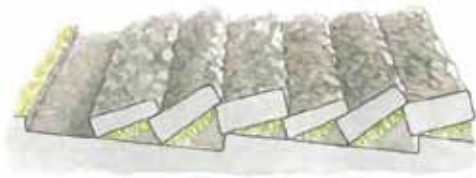
Ujevn pløgsle skyldes feil innstilling av plogen. Foto: Kari Bysveen.
