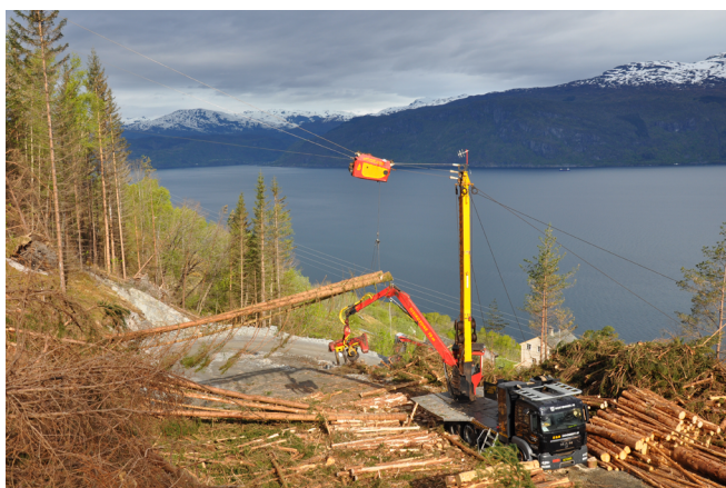
Figur 1. Taubaner spennes opp så tømmeret løftes ut av terrenget – dermed unngås alle driftsspor i de bratte liene (foto: Skog og landskap)
