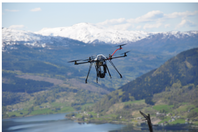
Figur 4. En drone ble anvendt til flybildene som omdannes til terrengmodellen med cm presisjon (foto: Skog og landskap)
