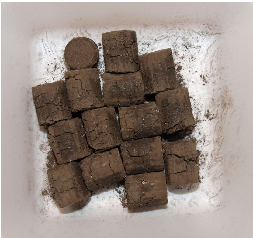
Figur 7. Askepellets laget av bunnaske. Foto: Kai Toven, PFI.
