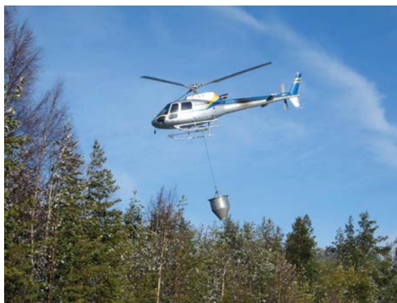
Figur 1. Spredning av aske kan skje med traktor eller lassbærer og spreder fra bakken (til v.) eller med helikopter (til h.). Foto: Steinar Wormdal og N. Huotari, Metla, Finland.
