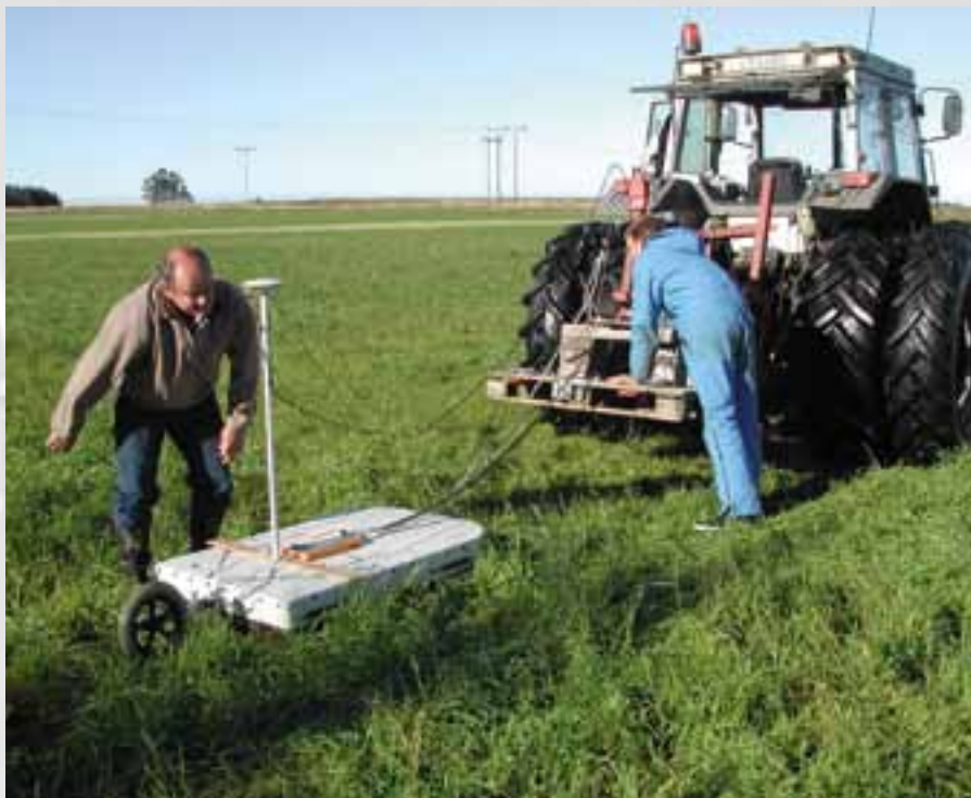
Bilete nr 1: Georadar i arbeid for å kartlegge djupna på myra (Foto: Olav Inge Edvardsen)
