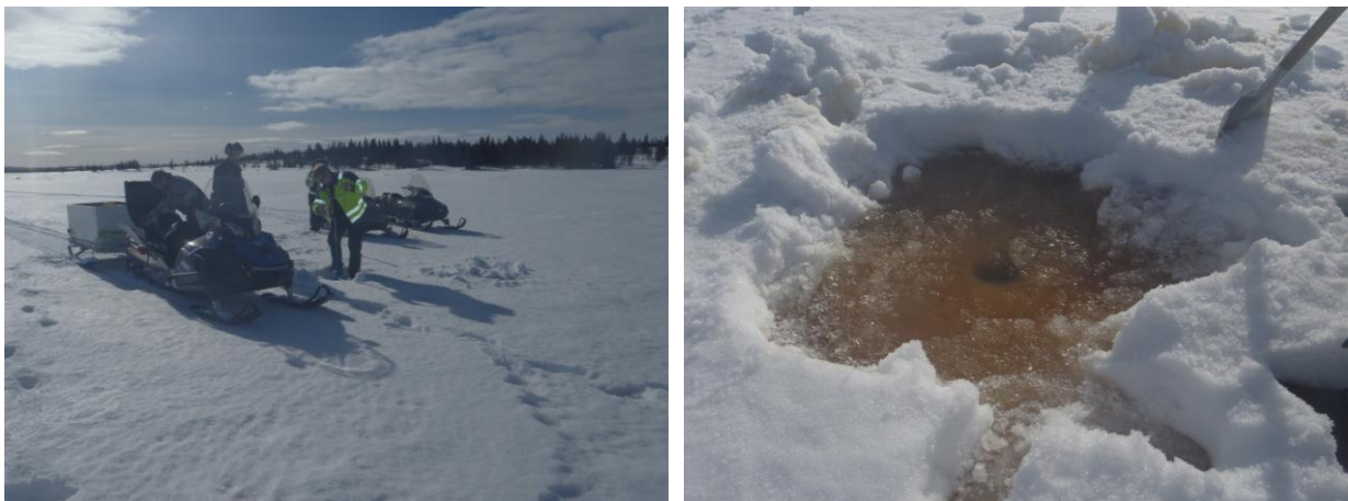
Figur 2. Bilder fra prøvetaking av Våsjøen om vinteren. T.v.: En multisonde fra SEBA (Kll-Q) ble senket ned under isen nær dypeste punkt i hvert basseng (basseng 1-3; fig 1). T.h.: Våsjøen har moderate konsentrasjoner av organisk materiale (om lag 6 mg TOC/l i bunnsjiktet) og er en del farget.
