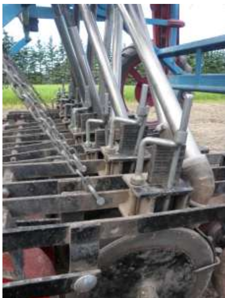
Bilde 28. Hver skållabb hadde individuell, trinnløs regulering av sådybden. Foto: Trygve S. Aamlid.
