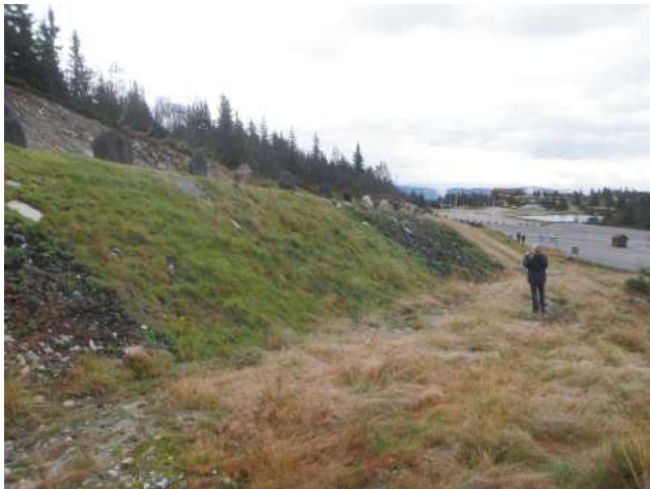
Bilde 36. Bernhard Krauzer tar bilde av vegskråningen på Lifjell 13.september 2011. Tre første ruter fra venstre: Usådd, importfrø og FJELLFRØ. Foto: Trygve S. Aamlid
