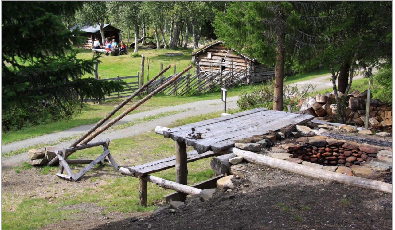
Spor etter jernvinna er kjent fra mange seterområder. På Storbekkvollen, setermuseet i Budalen, finnes rester av jernframstillingsanlegg fra ulike tidsperioder, i tillegg til tjæremiler, fangstgroper og andre kulturminner. Bildet viser en rekonstruert evenstadvn. Denne yngste typen av smelteovner for myrmalm var i bruk fra 1500- til 1700-tallet. Metoden er detaljert beskrevet av lensmann og bonde Ole Evenstad i Stor-Elvdal i 1782. Derav navnet på ovnstypen. Foto KAS, Midtre Gauldal i Sør-Trøndelag.
