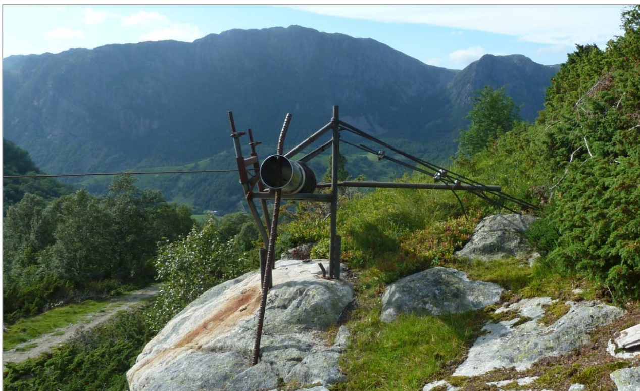
Løpestrengen kom i bruk tidlig på 1800-tallet, mest på vestlandstøler med kort og bratt avstand til gården. Her er en nokså ny utgave. Foto JRE, Forsand i Rogaland.
