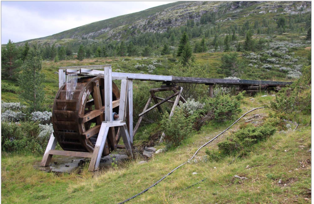
Å kinne smør var en tung jobb. Noen sette benyttet vannkraften fra bekken til å dra kinna ved hjelp av et vasshjul. Foto KAS, Nord-Fron i Oppland.
