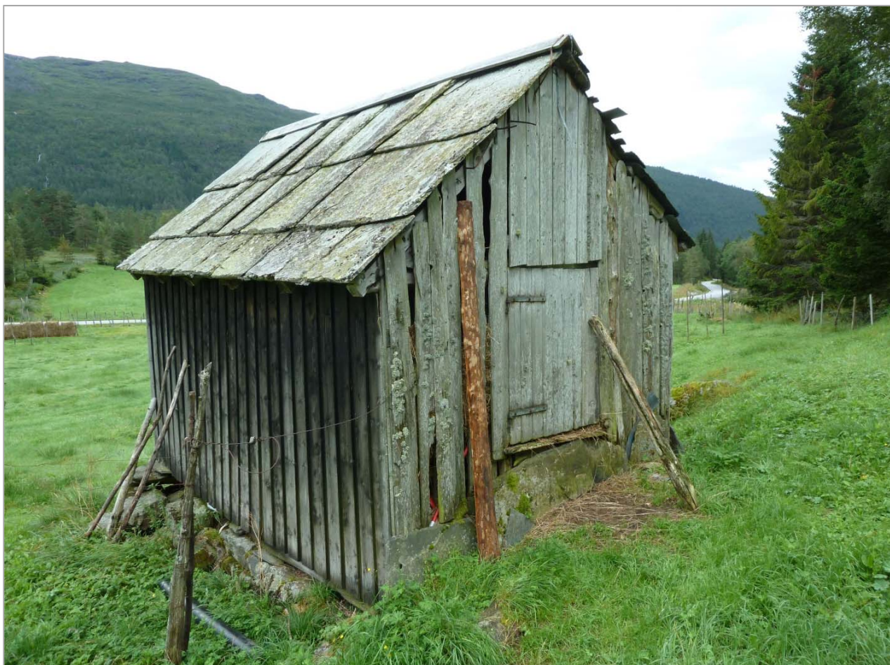
De få løene vi har registrert i Hordaland har alle skifertak. De store rastehellene er en spesialitet fra Hardanger. Foto WEF, Ullensvang i Hordaland.
