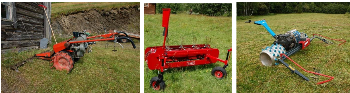
Figur 4.1.2. Lett maskinelt utstyr lettar arbeidet med å skjømte slåttemarkene. Det finst også utstyr spesielt eigna for bratt terreng. Foto: Bolette Bele/NIBIO.
