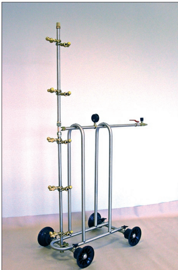
Figur 16. Eksempler på sprøytetårn i veksthusagurk, hvor dysene kan vinkles, eksempelvis oppover for bedre dekning på bladenes undersider. Foto: WanJet.
