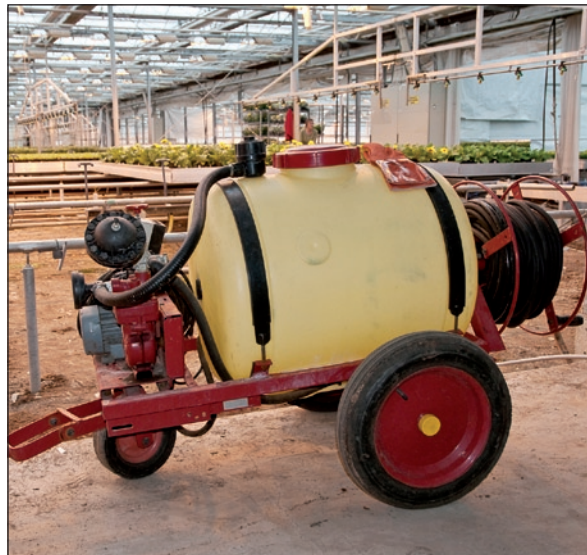
Figur 14. Eksempel på transportabel høytrykksprøyte (150 bar). Foto: Erling Fløistad.
