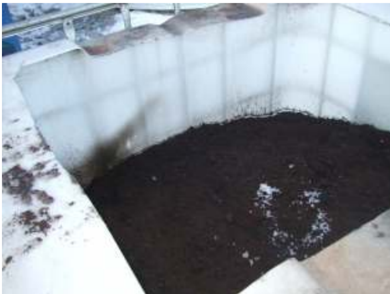
Figur 4. Åpen pallettank med brukt bleikejord fra G C Rieber, Kristiansund. Fettrikt biprodukt fra raffinering av fiskeolje. Bleikejord er pulver av mineraler som kalsiumkarbonat eller bentonitt. Foto Anne-Kristin Løes.
