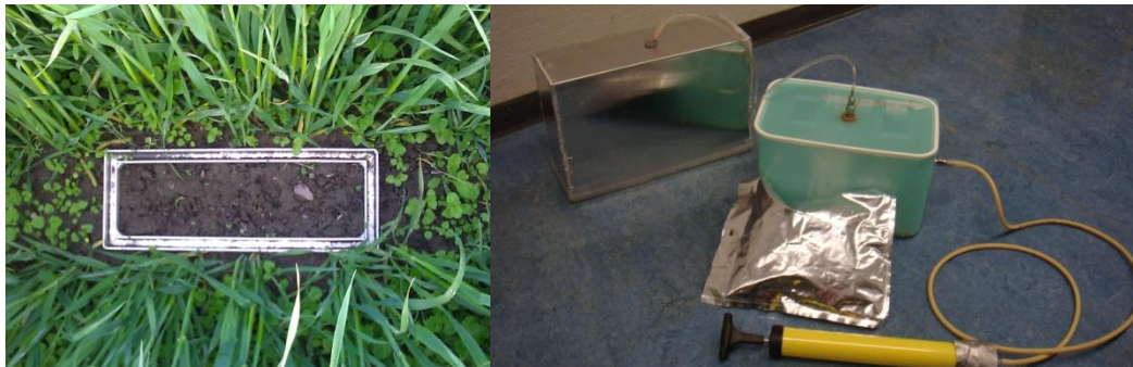
Bilde 1. Rammen kammeret plasseres på for å måle CO 2 fra jord (venstre) samt kammer og utstyr for gassuttak (høyre)
