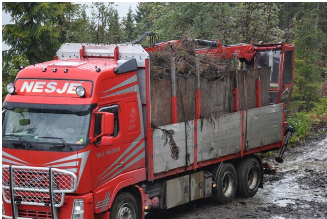
Figur 5. Tømmerbil med tette aluminiumskarmer og innlagte stålplater. Foto: Leif Kjøstelsen.
