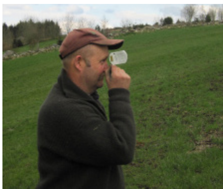
Stigningsmåler brukes til å måle dominerende hellingsgrad innenfor en jordfigur.
