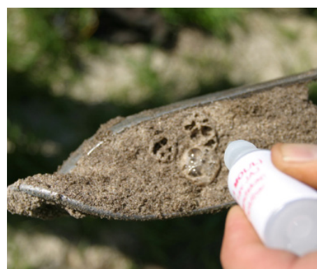
Ved hjelp av saltsyre testes jorda for skjellfragmenter.
