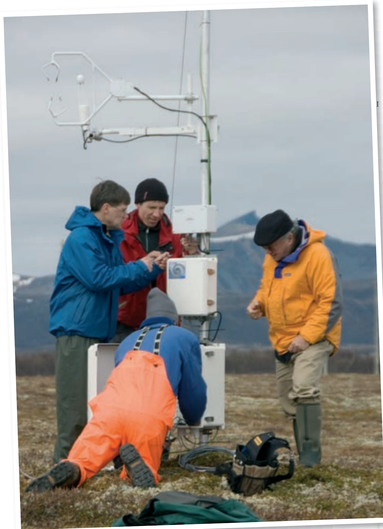
Montering av klimatårn på Andøya for å kunne måle utveksling av CO 2 - gass frå jorda.
