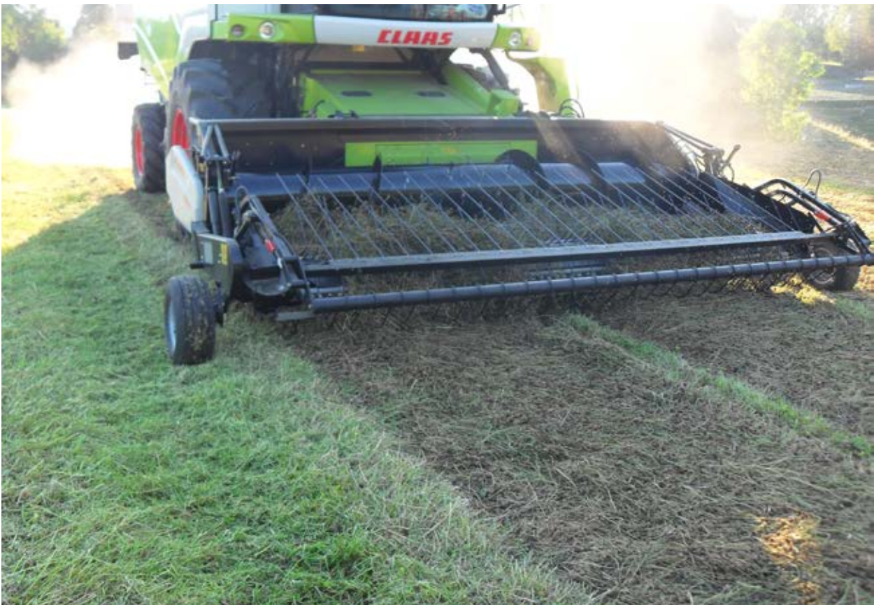
Bilde 4. Nils Olav Bjerva tresker skårlagt kvitkløverfrøeng med pick-up, ca. 20.august 2012. Foto: Hans Jørgen Bjerva.
