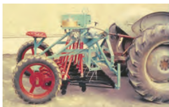
1967: Øyjords 10-raders traktormontert forsøks s å maskin
