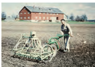
1958: Øyjords første forsøks s å maskin for Agria 1700 tohjulstraktor på Vollebekk forsøks gård i Ås
