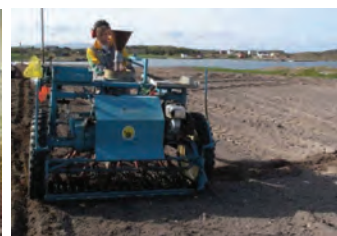
2012: Selvgående Wintersteiger (Øyjord spasertype) forsøks s å maskin hos Norsk Landbruksrådgiving Sør-Trøndelag
