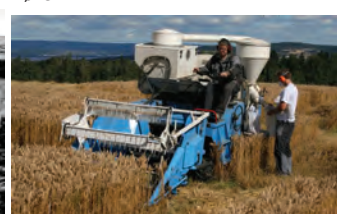
2008: Høsting av kornforsøk med Wintersteiger forsøks skurtesker på Bioforsk Øst Apelsvoll
