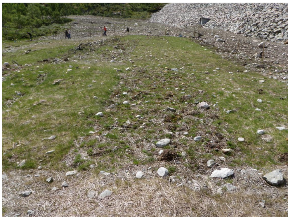
Bilde 21. Bitdalen 25.juni 2010. Nærmest fra høyre importfrø, usådd og norsk fjellfrø, alle på ukalka blandingsjord. Foto: Trygve S. Aamlid
