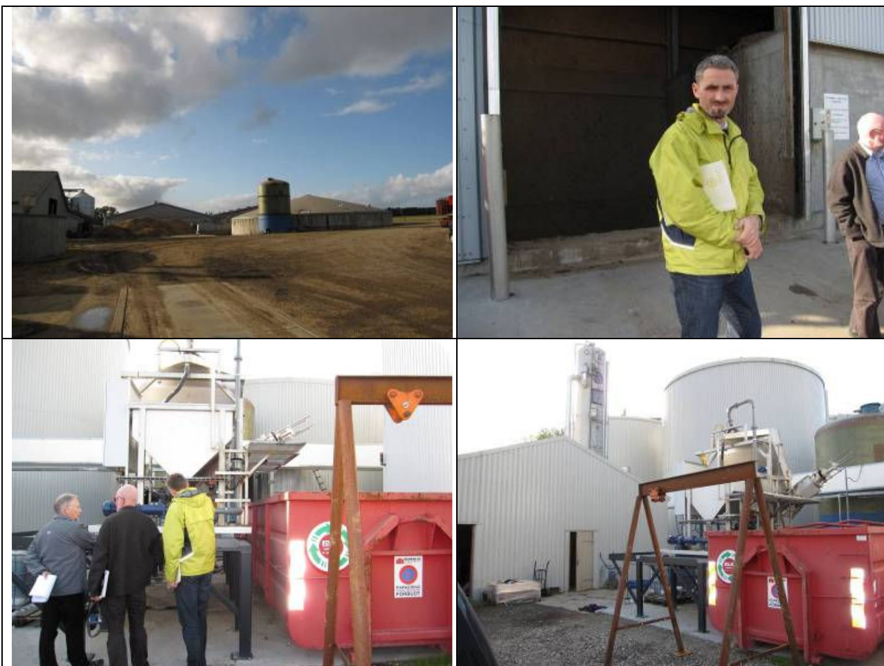
Bilder fra anlegget på Over Løjstrup. Øverst til venstre: Overbygd sluttlager med gasslagringstank. Til venstre, plansilo for oppsamling av tørt organisk avfall. Her korn av for dårlig kvalitet for fôrindustrien. Øverst til høyre: Jens Måge og Stellan Dahlberg fra BioWaz foran tømmegropa for våtorganisk avfall. Herfra pumpes avfallet inn i trykkokeren. Nederst til venstre og høyre: Kvern for findeling av fast organisk materiale, som leveres i containere a la den røde vi ser på bildet. Nederst til høyre se vi rensårnet for svovel. Alle foto: Kristin Sørheim.
