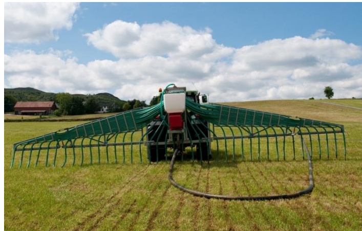
Figur 3. Agromiljø AS sin AM stripespreiar med slepeslange brukt til vedlikeholdssåing i eng. Foto: Agromiljø AS.
