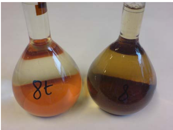
Figur 1 Ekstrakt for måling av total P og uorganisk P sto i ro på benken minst to dager for å sedimentere finpartikler. Bunnfall i glødet prøve av FREVARslam ble jernrødt. Til høyre er ekstrakt av samme slam som ikke er glødet.
