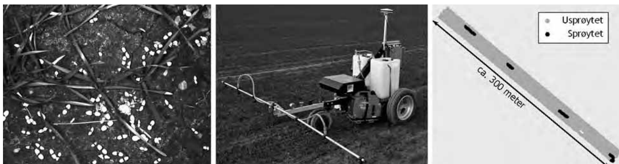
Figur 1. Eksempel på bilde analysert med Weed_class.exe; detekterte ugras er markert hvite. I midten: Fleksksprøyting i sanntid med robot utstyrt med kamera, GPS, PC, tank, og sprøytebom. Til høyre: Sprøytekart for felt nr. 6.
