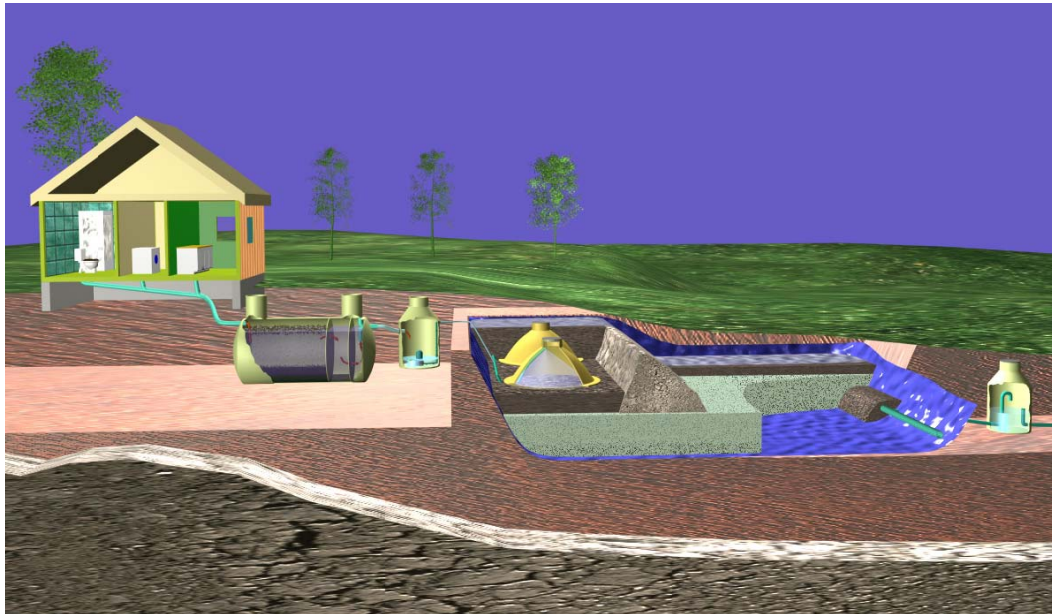
Figur 4: Prinsippkisse av filterbedanlegg
