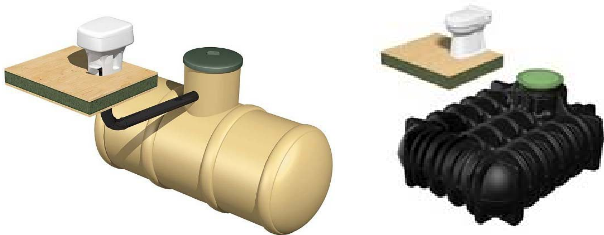
Figur 7: Prinsipp-skisser av samletanker for toalettavløp
