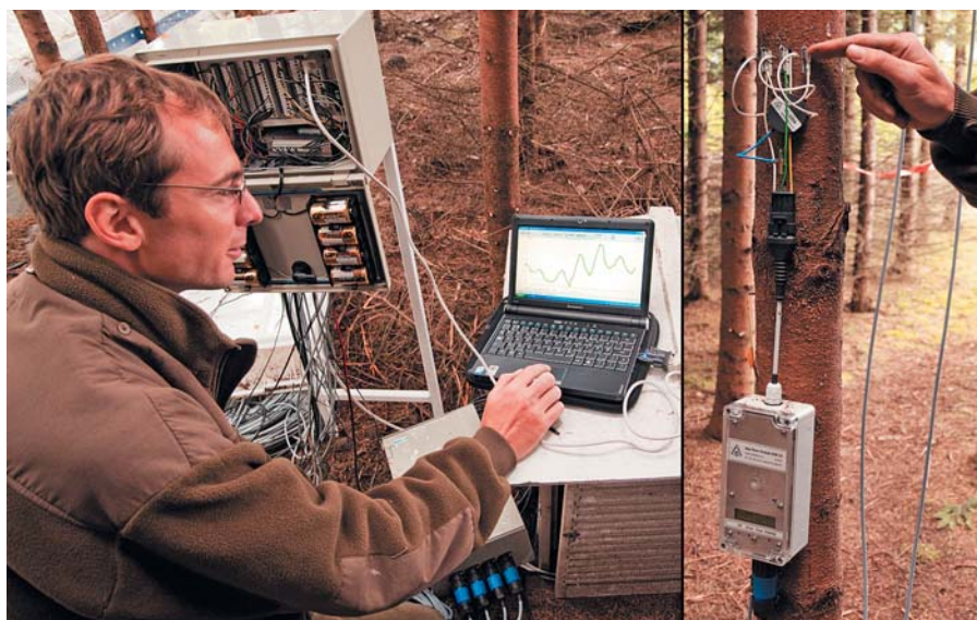
Detaljebilde av sensorene som måler vanntransporten i veden (til høyre). Josef Urban fra Mendel-universitetet laster ned data fra disse og andre sensorer i trærne og jorda. Foto: Isabella Børja.
