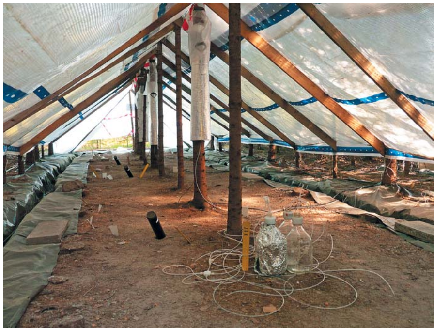
Tørkestressede grantrær som har stått under et plasttelt i nesten 2 år. Teltet og grøftene langs sidene hindrer at regnvannet kommer til trærne. Flaskene samler jordvann fra lysimetre i jorda, svarte rør er kikkhull ned i rotsystemet (minirhizotroner), og de små hvite lappene som stikker opp fra jorda er rotnett. Trærne som er pakket inn i folie er våre forsøkstrær. Folien beskytter sensorene som måler vanntransporten i veden og dendrometerne som måler ørsmå endringer i stammens omkrets. Foto: Isabella Børja.
