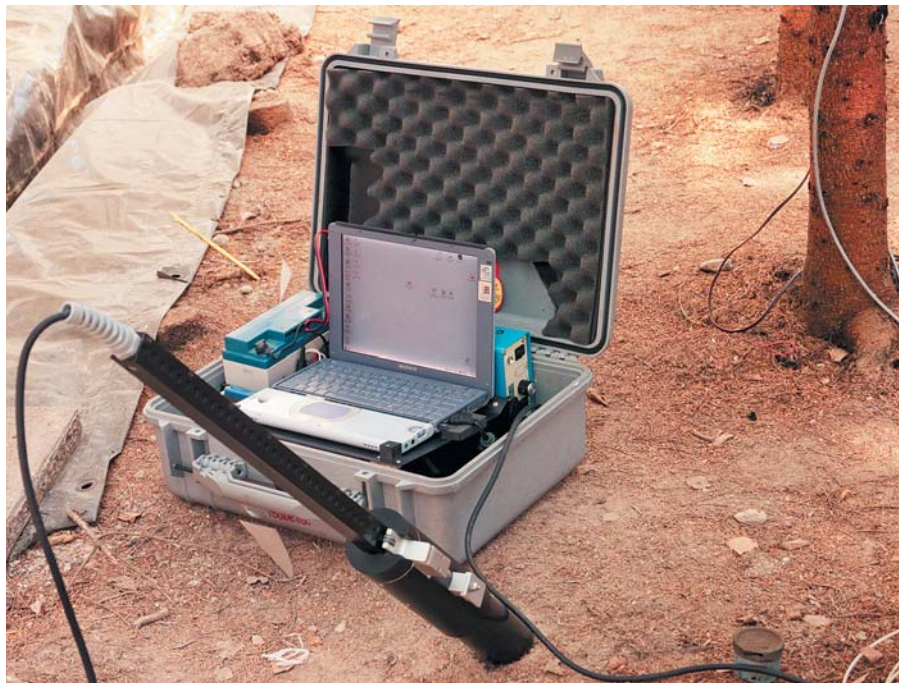
Kikkhull ned i rotsystemet (minirhizotron) med kamera montert. Foto: Isabella Børja.
