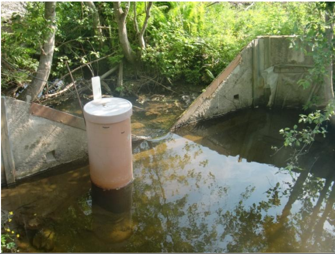
Figur 2. Måleprofil i Kolstadbekken. Foto: Bioforsk.
