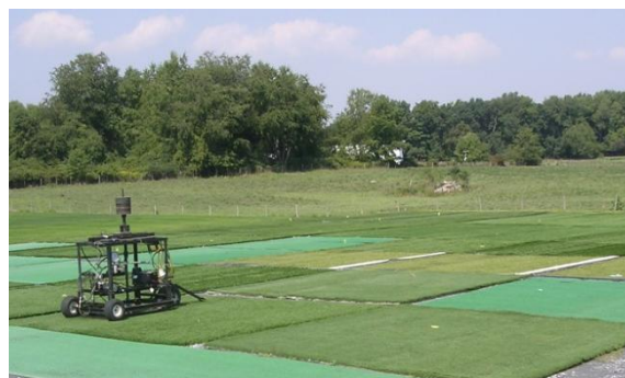
Bilde 23: På forsøksfeltet ved Penn State University, USA, brukes en kunstig fot, "Pennfoot" til å måle kreftene mellom fot og gressdekket. Foto: Trygve S. Aamlid
