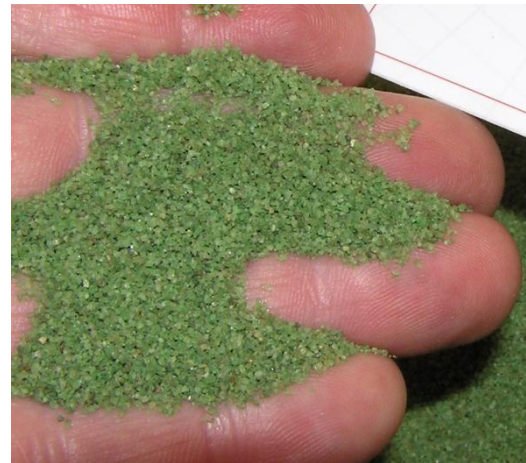
Bilde 22: Sand med plastovertrekk er også et alternativt fyllmateriale. Foto: Agnar Kvalbein
