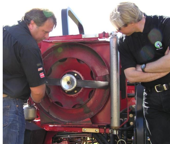
Bilde 8: Rotorklippere med valse kan gi fine striper. Også disse slagjerna må holdes skarpe. Foto: Agnar Kvalbein
