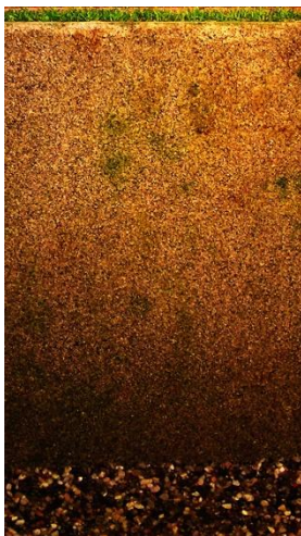
Bilde 4. Jordprofil som er bygget bak en glassplate. I de mørke områdene ned mot gruslaget er porene fylt med vann. Foto: Agnar Kvalbein
