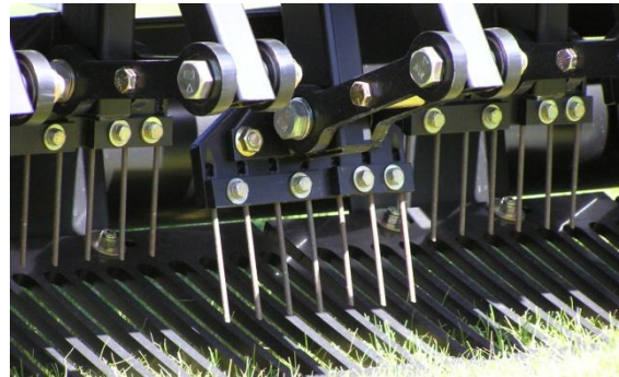
Bilde 12: Den vanligste luftemaskinen stikker pinner ned og brekker forsiktig bakover. På fotballbaner er det vanlig med tykkere pinner enn disse, som bare er 6 mm tykke. Foto: Agnar Kvalbein
