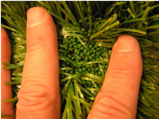
Bilde 21: Det vanligste fyllmaterialet er granulat fra resirkulerte bildekk. Her er det brukt industrigummikuler, ofte av materiale kalt EPDM. Foto: Agnar Kvalbein
