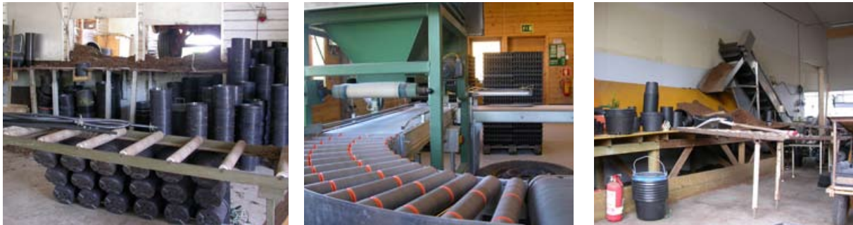
Figur 19 Ein må ha gode rutinar med å halda arbeidsrom reine for jordrestar. Vidare er det viktig at bøtter og andre reiskapar som vert brukt ute, eller har vore i kontakt med golvflater der ein ferdast, ikkje vert sett opp på benkar eller transportband der ein handterer reine potter/brett og vekstmedium.
