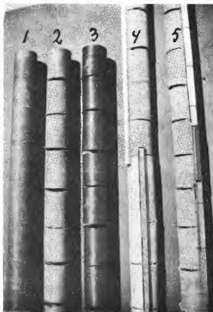
Fig. 1. 1) Fuktig rør uten sprekkdannelse. 2 og 3) Tørre rør. 4) Rørskjøt. 5) Rørskjøt med platelås.
