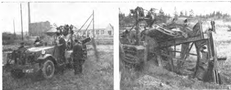
Fig. 4. Finsk maskin av gravehjulstypen bygget ved hovedverkstedet til Pellonraivaus Oy.
