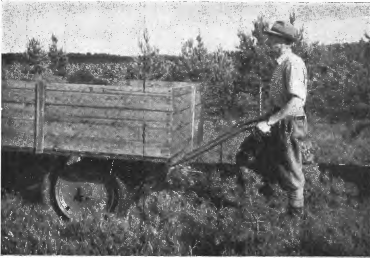
Fig. 3. Allen motorslåmaskin ombygget for transport av torv. (Fot.: Aa. L.)
