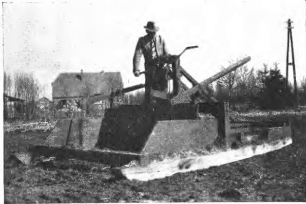
Fig. 6. Fra Emsland, Vest-Tyskland. Tuehøvel. Redskap til planering på myr.
