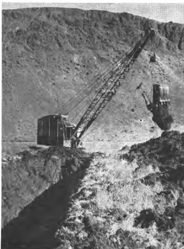
Fig. 3. Gravemaskin av slepe-skovltype i arbeid på Sør-Island.
