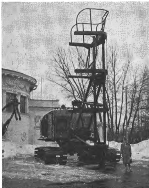
Fra torvavdelingen ved landbruks- og industriutstillingen i Moskva. Maskinen på bildet viser en Universal ekskavator konstruert for rydding av krattskog og felling av trær opp til 25 cm i diameter.
