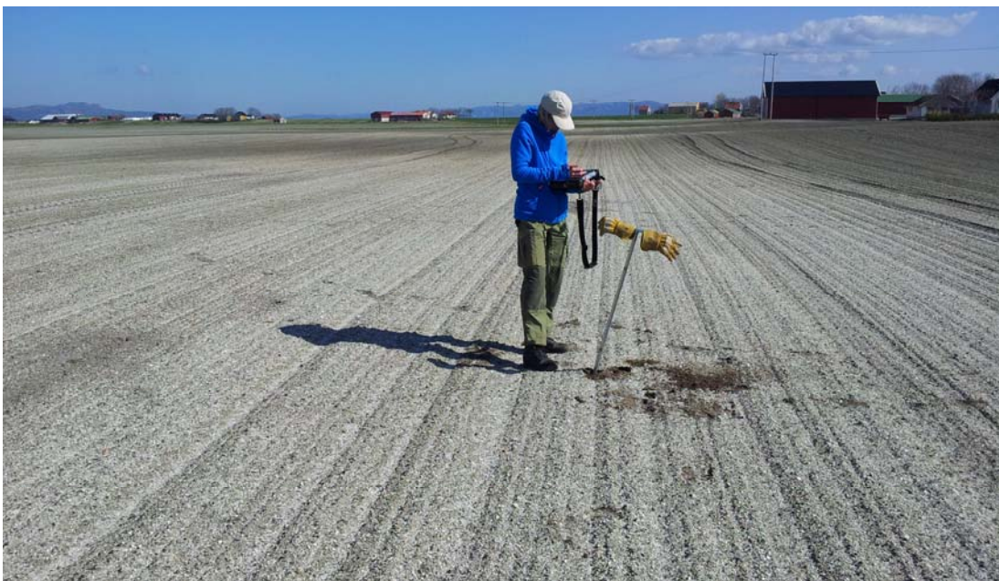
Figur 1: Jordkartlegger i arbeid under jordkartlegging i Ørland kommune. Jordbor, feltpc med innebygd GPS samt lang erfaring er de viktigste hjelpemidlene i en jordkartleggers arbeid ( Åge Nyborg /NIBIO)
