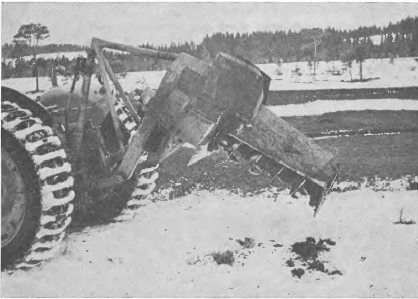
Fig. 4. Ko-Po grøftefres i hevet stilling. Fresen er 3 punkt-festet til traktoren. Den er lett å kjøre.
