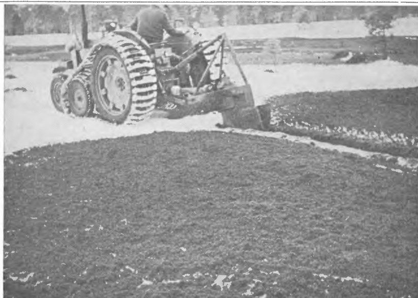
Fig. 3. Ko-Po grøtefres arbeider meget godt på myr med 50—70 cm tele. Myrmassen spredes utover, men kan også samles med en skjerm som monteres på siden.
