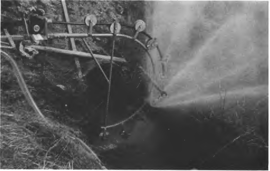
Spylehodet gir en stråle rett forover og tolv stråler skrått bakover.
