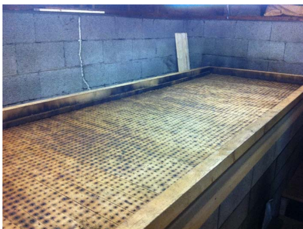
Fig 12. og 13. Perforert plate til tørking av maltet i et tradisjonelt malteri, et såkalt «Såinnhus».
