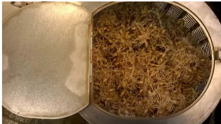
Fig 14. Maltetromler i prøvemalteriet ved NMBU på Ås. Her er kornet ferdig spiret.
