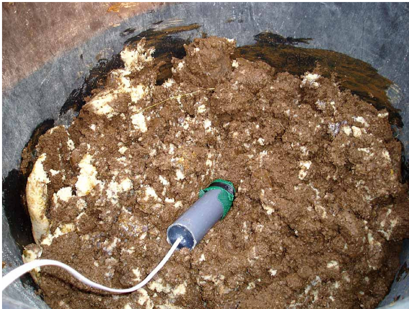
Bilde 10. Oksygensensor under påfylling av jord blandet med potetrev. Oksygensensor ble plassert i nederste halvdel av massene.
