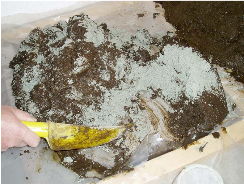
Bilde 3. Innblanding av olivin i DDT-forurenset sediment (biopile 2).
