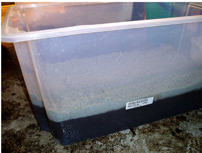
Bilde 7. In-situ tiltak for nedbrytning av DDT i sediment under vann ( in-situ vann). Forurenset sediment med et lag olivin før tilsetning av vann.
