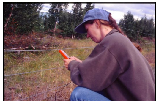
Regelmessig sjekking av spenningen på gjerdet er viktig (foto: R. Bjøru). Regular checking of the voltage at the fence.
