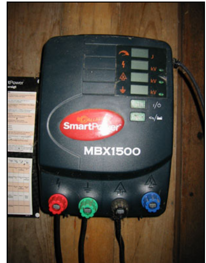
Gjerdeapparat med display for lagret energi, utgående og inngående spenning og for overvåking av jordingsanlegget (foto: I. Hansen). Energizer with display for stored energy (J), in and outgoing voltage (V) and earth voltage (V).
