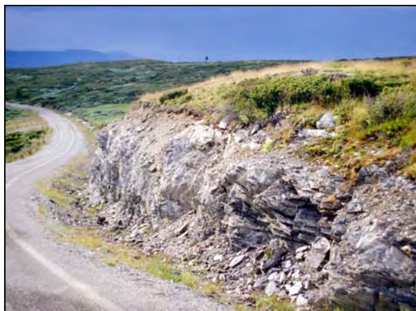
Lett forvitterlig fyllitt. Nord-Aurdal, Oppland (MIA). Tungt forvitterlig sandstein. Sør-Fron, Oppland.
