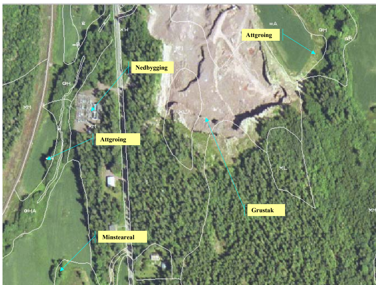
Figur 4. Ortofoto i kombinasjon med eldre FKB er eit framifrå hjelpemiddel til å avdekkje feil og endringar.
