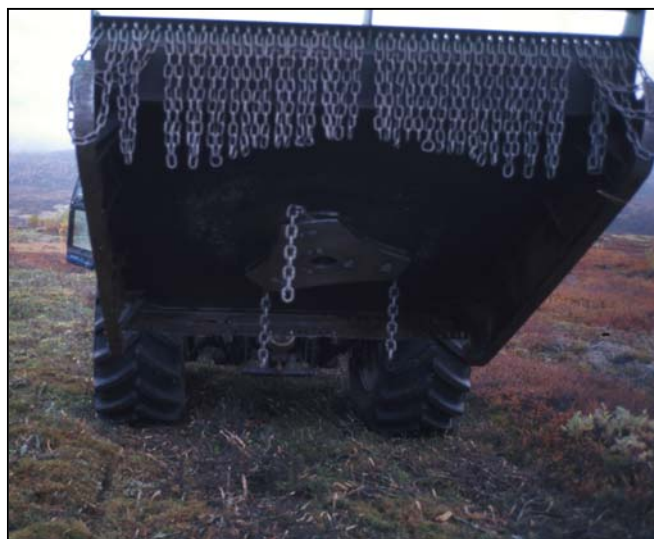
Bilde 1. Eksempel på krattknuser med roterende kjettinger. Foto A. Bryn.
