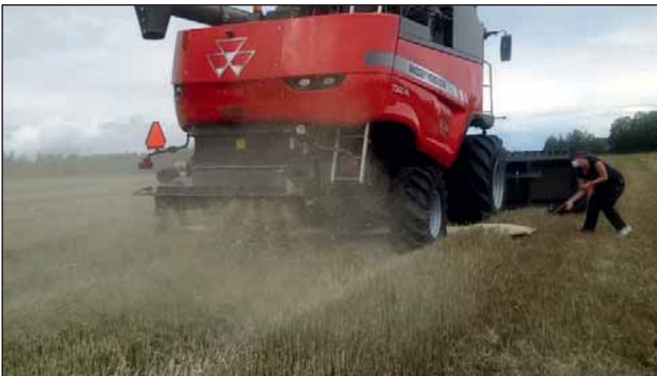
Bilde 2: Anne Cecilie Olsen plasserer en oppfangerplate under treskeren ved 2. gangs tresking. Foto: Ellen Rove.
